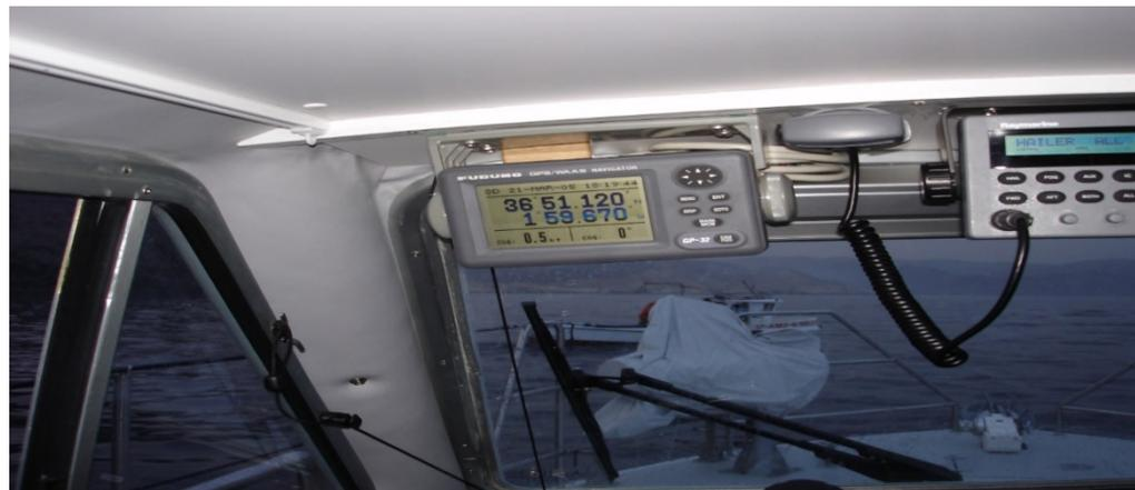
Las unidades de mayor porte deberán contar también con otros equipos como radar, cartografía electrónica (plotter) y sonda. Es recomendable que cada equipo que proporcione posición disponga de su propia antena de recepción de señal G.P.S. a efectos de verificación de la exactitud de las posiciones.
